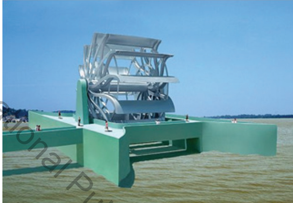
රූපය 1.98 - මුහුදු රළවල ඇති වන වාලක ශක්තිය ප්‍රයෝජනයට ගෙන විදුලිය නිපදවීම
