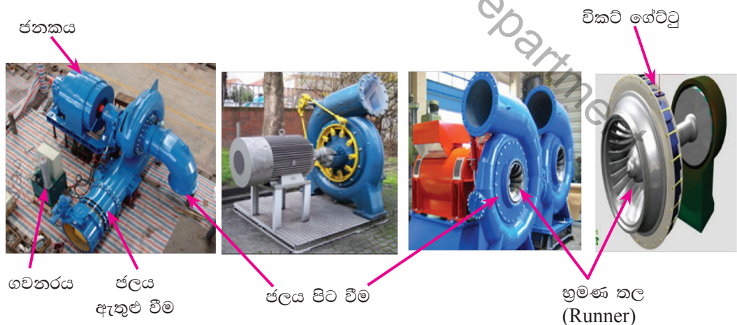
රූපය. 1.92 - ෆ්‍රැන්සිස් තලබමරයකින් ක්‍රියා කරන ජල විදුලි බලාගාරයක ප්‍රධාන කොටස්
