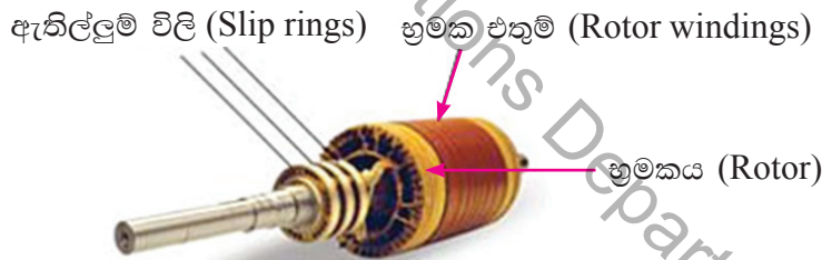
රූපය 1.36 - ඇතිල්ලුම් විලි හෝ එතුම් සහිත භ්‍රමකය (slip ring or wound rotor)
