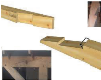
රූපය 1.72 - කයිනොක්ක මුව්ටුව (Scarf Joint)
