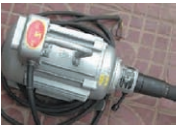
a ජවය ලබා ගන්නා යන්ත්‍ර කොටස (Concrete Compaction Machines)
