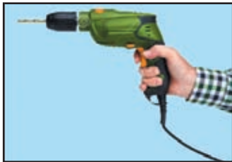
(b) විදුලි අත් විදුම් යන්ත්‍රය (Electrical Hand Drill)
