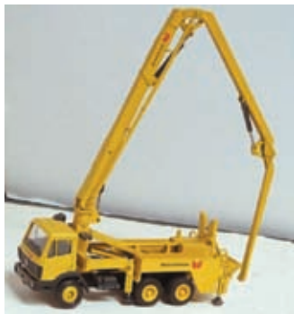
රූපය 1.130 පම්ප් කාර් රථයක් (Pump Car)
