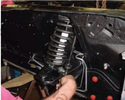
රූපය 1.156. දඟර දුනු (Coil springs) භාවිත අවස්ථාවක්
