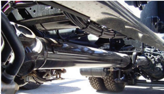
රූපය 1.102. අවරපෙති කඳ (Propler shaft) සහ දසන මුට්ටු (Universal joints) වාහනයක සවි වී ඇති අන්දම
