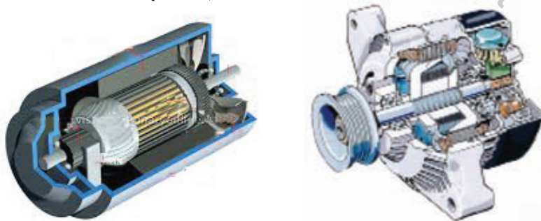
රූපය 1.137 සරල ධාරා ජනකයක හා ප්‍රත්‍යාවර්තකයක හරස්කඩක්
