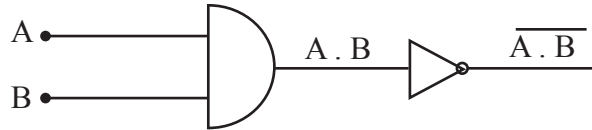
රූපය 1.123 - AND හා NOT ද්වාර යොදා NAND ද්වාර ක්‍රියාව ලබා ගැනීම
